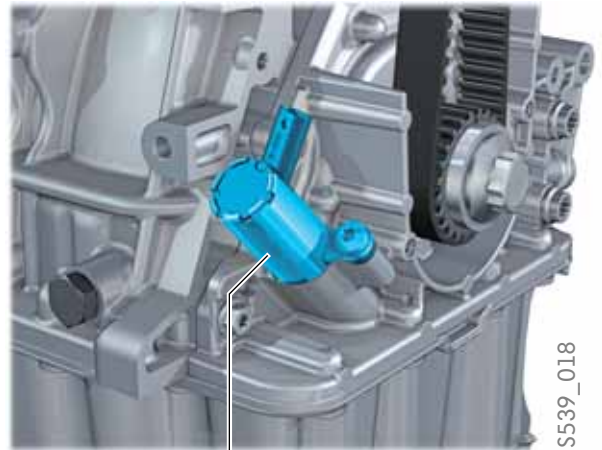
Klep voor oliedrukregeling N428
