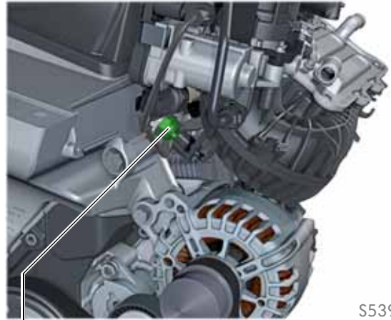
Oliedruksensor G10
