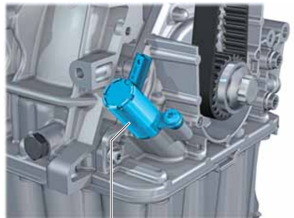
Klep voor oliedrukregeling N428
