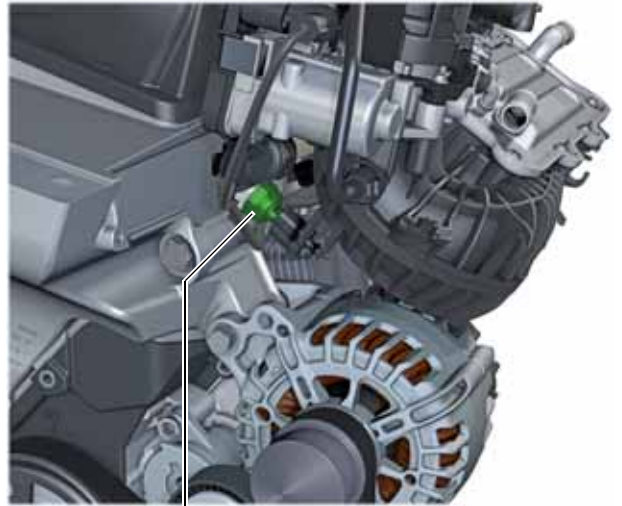
Oliedruksensor G10
